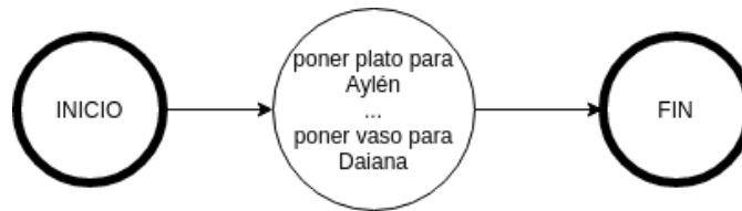
Figura 7: Control Flow Graph para el programa 1. Tiene un único bloque básico porque el programa consiste en una lista secuencial de tareas. La complejidad ciclomática de este programa es 1.
